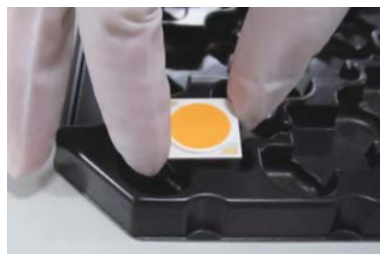
Figure 5 梱包トレイ取出し方法
