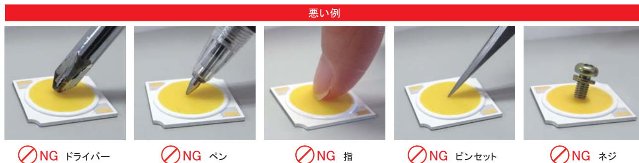
■ Figure 7 樹脂部取り扱い、構成部品接触に注意
