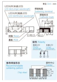
包装数量:3,000个/卷( \$\phi\$ 180mm) Loaded quantity:3,000pcs./1 reel( \$\phi\$ 180mm)
